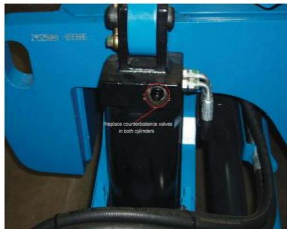
**OBS: Ao realizar procedimentos de verificação nas válvulas de contrabalanço, certifique-se das condições seguras para realização desse procedimento.**
