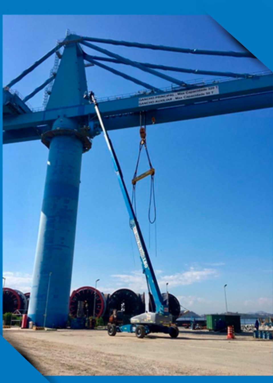
Genie® SX™-180 da Mills trabalhando em manutenção de guindaste portuário, na cidade de Niterói-RJ
