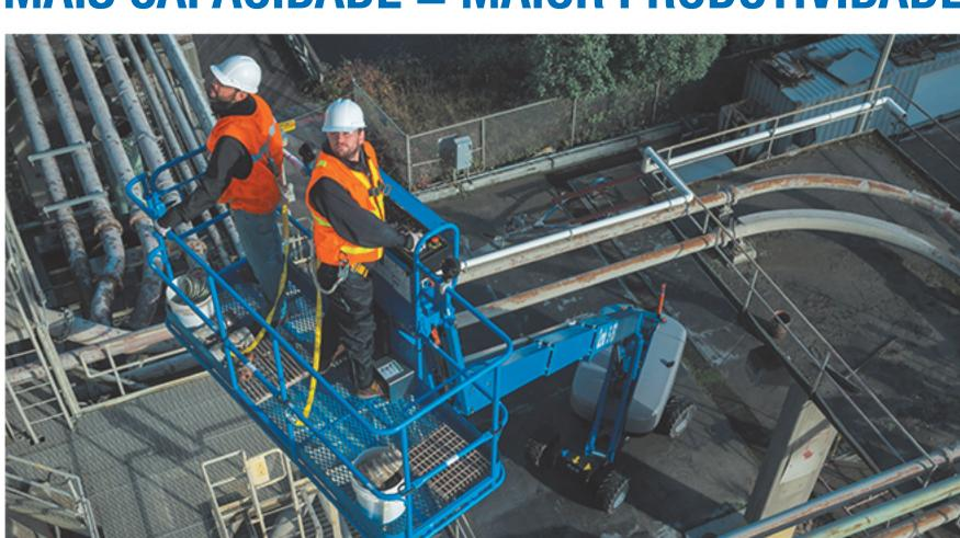
As lanças telescópicas Genie® S®-80 XC™ e S®-85 XC oferecem uma capacidade de elevação dupla, com 660 lb (300 kg) sem restrições e 1.000 Ib (454 kg) com restrições, para realizar uma ampla gama de tarefas pesadas de içamento em canteiros de obras industriais e de construção.
