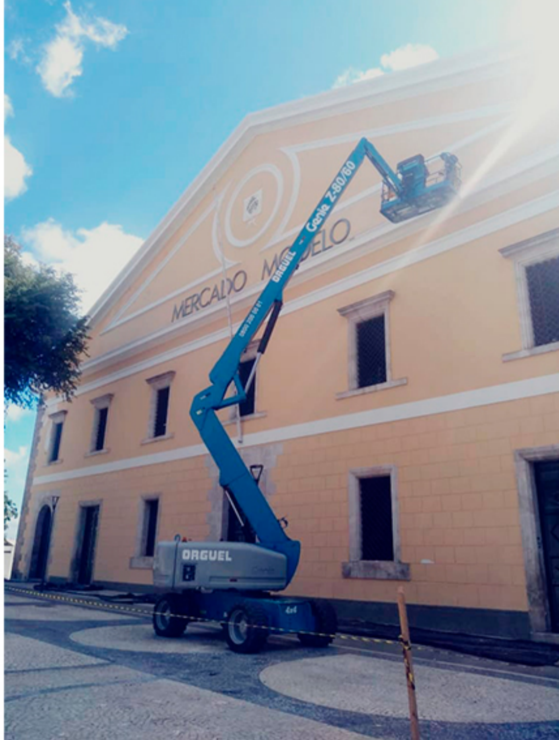
Brazo articulado Orguel Genie® Z-80/60, trabajando en el mantenimiento del Mercado Modelo en Salvador, Bahia
